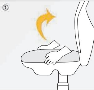
座マット前方のウレタン部分と座シェルの隙間から座マットを持ち上げてクリップを外します。
