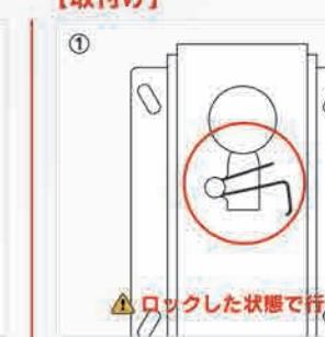
ストッパーのバネを持ってピンから外すことで、金具が外れロック解除となります。上部を両手で掴み、左右に振りながら持ち上げて取外します。
