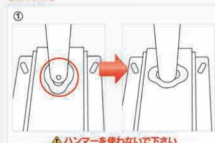
ポールのネジがスライドの凹に合わさるように差し込み白いキャップを90度回すと、元の位置に戻りロックされます。
