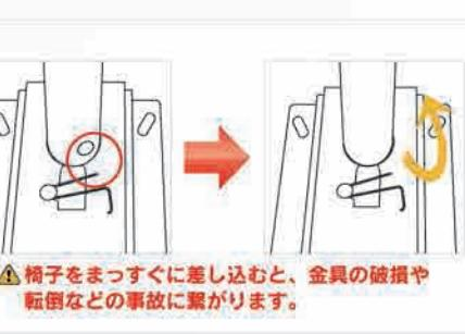
上部を取付ける時は、必ずストッパーのバネを元に戻します。
