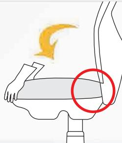
座シェルと座マットのクリップ位置を合わせて、先端から順番にクリップを抑えこみながらはめ込みます。
